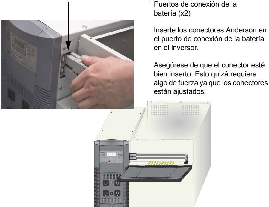
Figura 3-5 Conexión del banco de batería al inversor
