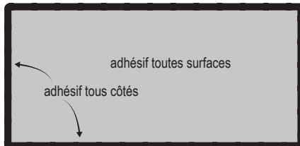
Figure 3 Bandes adhésives au dos du panneau
